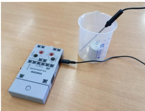
Рисунок 1. Использование цифрового датчика температуры при исследовании скорости охлаждения водных растворов соли
